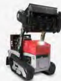
Broyeur forestier d'un mètre de haut capable d'effectuer des travaux entre les lignes, les routes étroites, les autoroutes et les fossés. Puissance de coupe élevée avec arbres hybrides, lames / marteaux ou Forest 360°.
