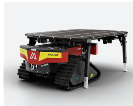
Système de plateau mobile extensible incluant les rails d'arrimage pour une flexibilité maximale et un transport sûr
