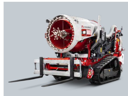
Utilisation flexible et extensible, par exemple avec des fourches de levage
