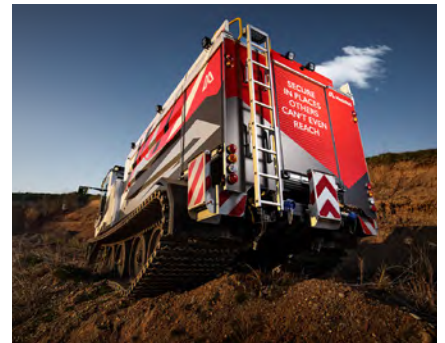
Charge utile élevée, pression au sol minimale : 30 fois moins de pression qu'un véhicule 6x6
