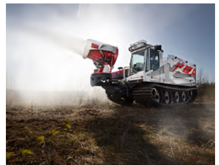
Utilisation massive d'agents mouillants grâce à la technologie de brumisation AirCore
