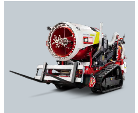
Avec sa hauteur > à 2m et de nombreuses options comme les fourches de levage, le TAF35-C peut être utilisé pour des missions spécifiques comme l'extraction de véhicule
