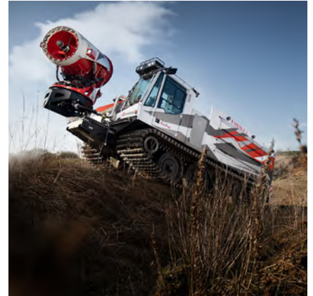
Là où les véhicules atteignent leurs limites, la transmission à chenilles apporte de l'agilité tout en assurant un haut niveau de confort de conduite
