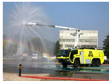
Canon extensible à grande portée (HRET) en option pour une flexibilité maximale lors de l'utilisation du moniteur.
