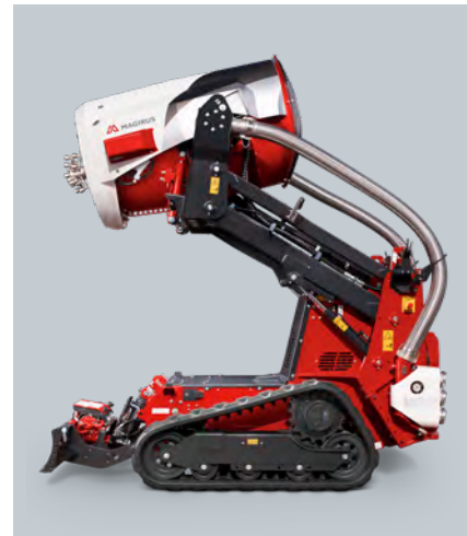
Multifonctionnel & modulable : turbine relevable et basculable, convient pour la brumisation d'eau, de mousse, de retardateur et d'additifs
