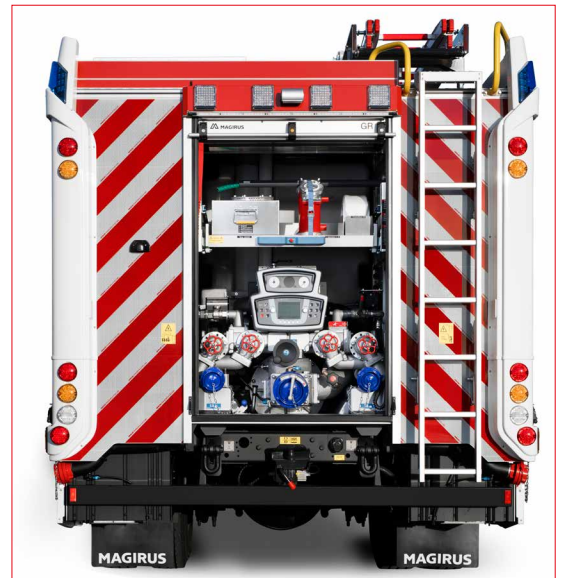
Panneau de contrôle HMI
