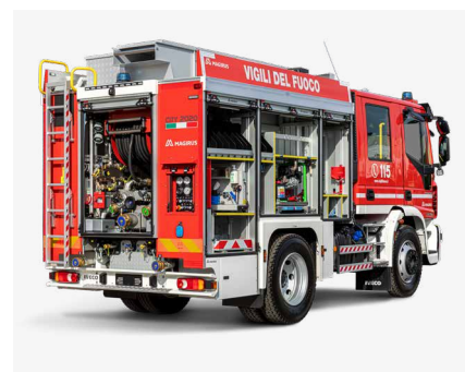
Structure en aluminium avec 3 compartiments sur chaque côté et un compartiment arrière
