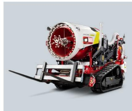
Avec sa hauteur > à 2m et de nombreuses options comme les fourches de levage, le TAF35-C peut être utilisé pour des missions spécifiques comme l'extraction de véhicule
